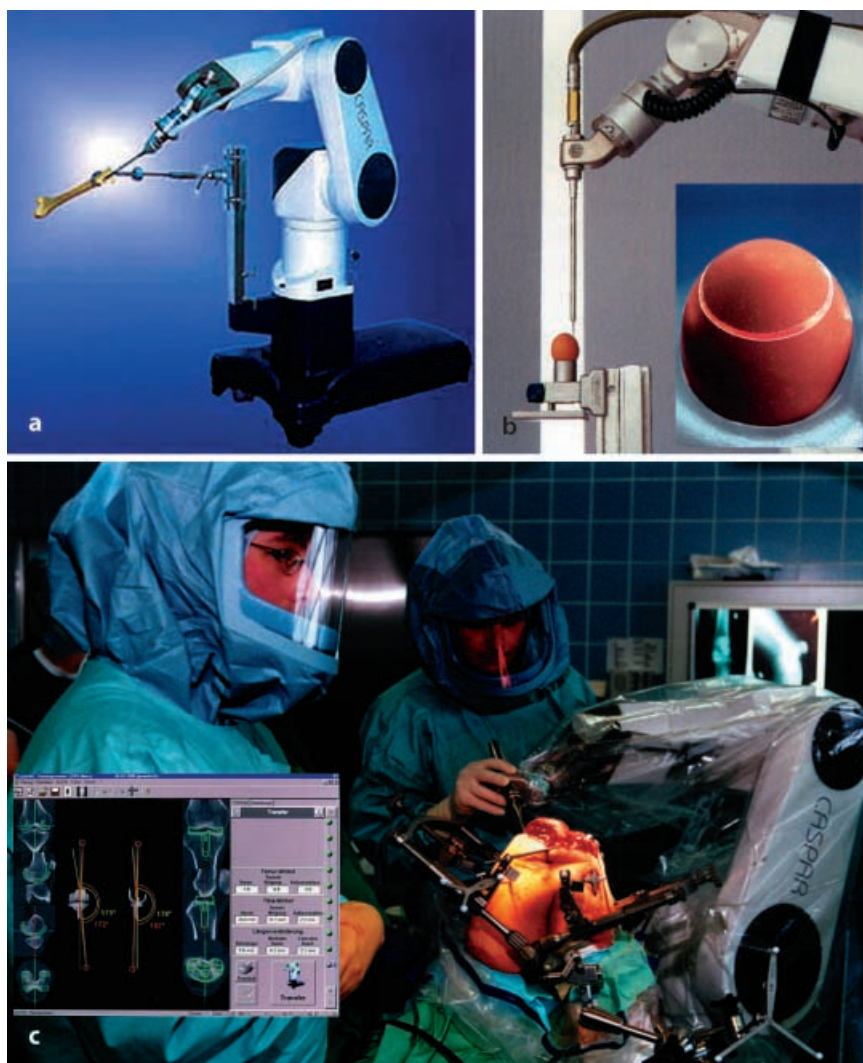
Abb. 6 ▲ a Operationsroboter CASPAR®; b Demonstration der hochpräzisen Fräsung an einem rohen Ei; c Operationssitus bei einem Eingriff am Knie mit dem Bildschirm des Planungssystems als Insert. (Mit frdl. Genehmigung von ortoMaquet)
